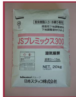
**施工上の注意** ●現場で水以外は混入しないで下さい。 ●清水には、水道水を使用して下さい。 ●塗り付け施工からモルタルが硬化するまで気温5℃以上を維持し、凍結防止の為に適切な養生を行って下さい。 ●直射日光の当たる所、通風の激しい場所での施工ではシート等で養生を行って下さい。 ●練り混ぜた材料は、1時間以内に使用して下さい。 ●直射日光下及び3℃以下での保管は避けて下さい。 ●湿気や雨掛かりに注意して保管して下さい。 **安全上の注意** ●取り扱い際は、保護メガネ・保護手袋等の保護具を着用して下さい。 ●取り扱い後は、顔・手・口等を洗浄して下さい。 ●材料が目に入った場合はただちに水洗いをしてすみやかに医師の診断を受けて下さい。 ●セメントのアルカリ分が皮膚の炎症をおこすおそれがありますので、かゆみや炎症等の症状のある場合は、すみやかに医師の診断を受けて下さい。 ●飲み込んだ場合は、直ちに吐かせ医師の診断を受けて下さい。 ●漏出した製品が河川・下水道へ流入すると環境を汚染するおそれがありますので充分注意して下さい。
